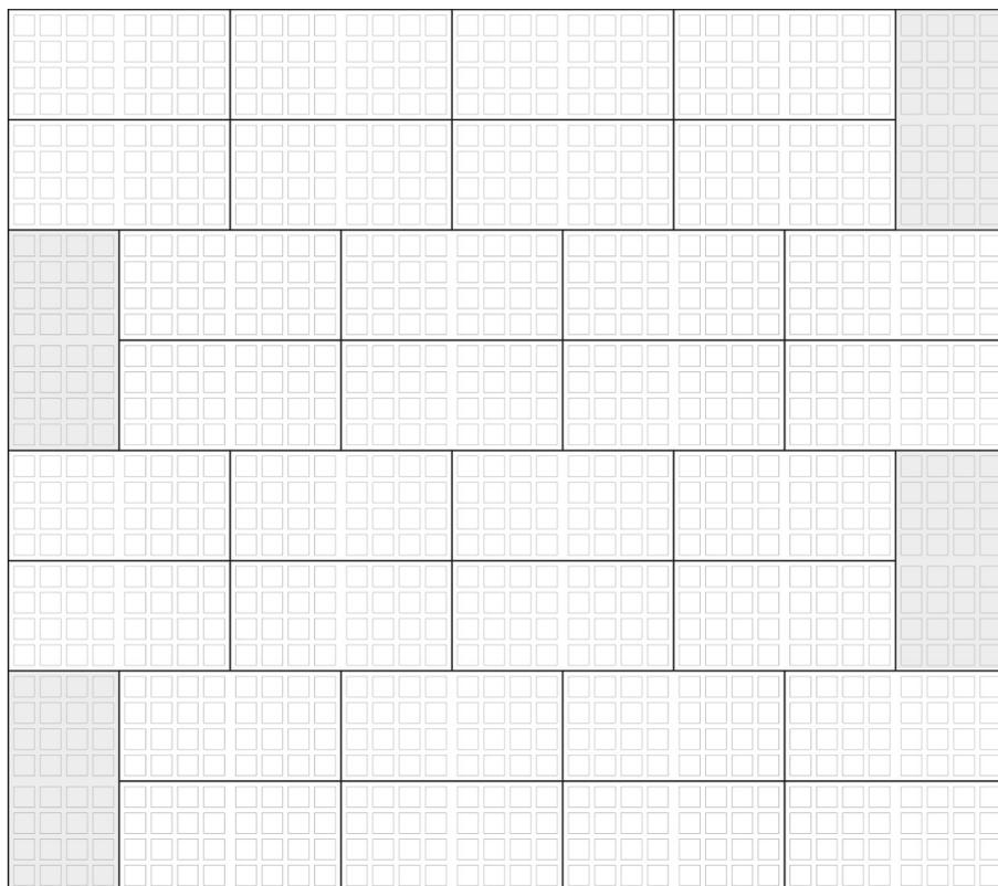
Кроме того, это один из декоративных вариантов перевязки. Из-за наличия крестообразных стыков распределение нагрузки не самое лучшее, поэтому такую перевязку используют на площадках с небольшой нагрузочной способностью
